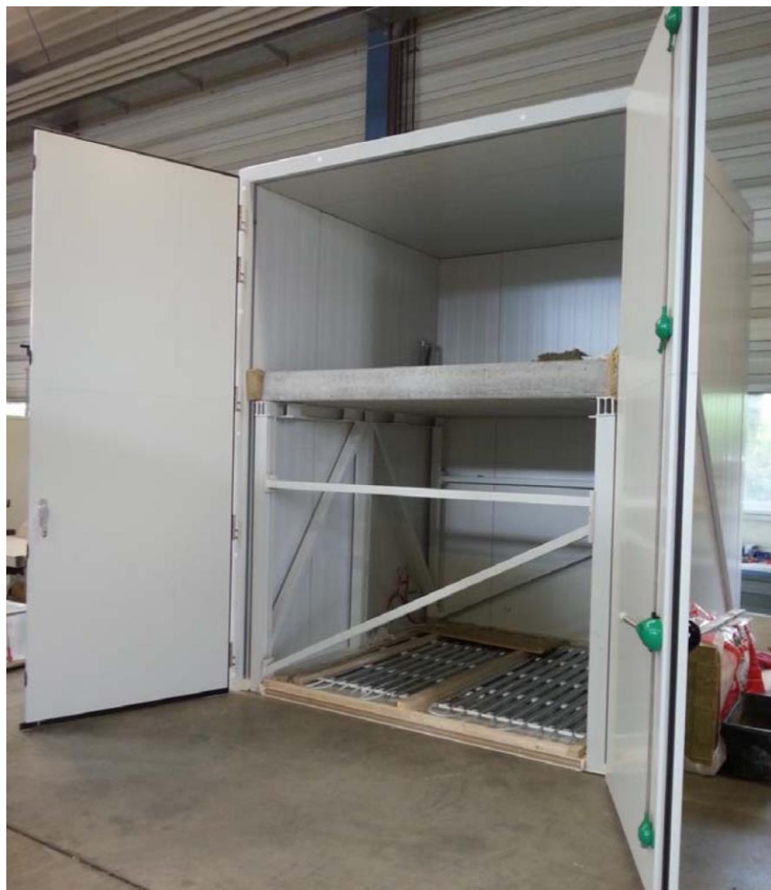
Obr. 3: Otevřené zkušební zařízení pro stropní desky s nainstalovanou měřicí technikou a izolací zkušebního tělesa
